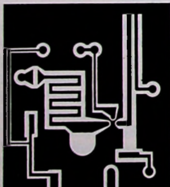
Figuur 4a en 4b. Afdrukken van de boven- en onderzijde van de gedrukte schakeling voor de UHF-versterker uit figuur 2 (ware grootte).
